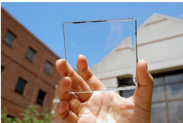
Abbildung 1: Transparente Solarzelle; Foto: Richard Lunt / Michigan State University (1)
