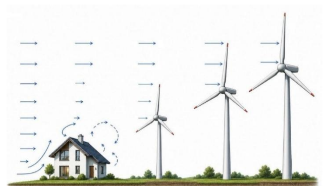
Abbildung 1: Schematische Darstellung des Einflusses urbaner Hindernisse auf WEA unterschiedlicher Nabenhöhen (eigene, qualitative Darstellung nach (0))
